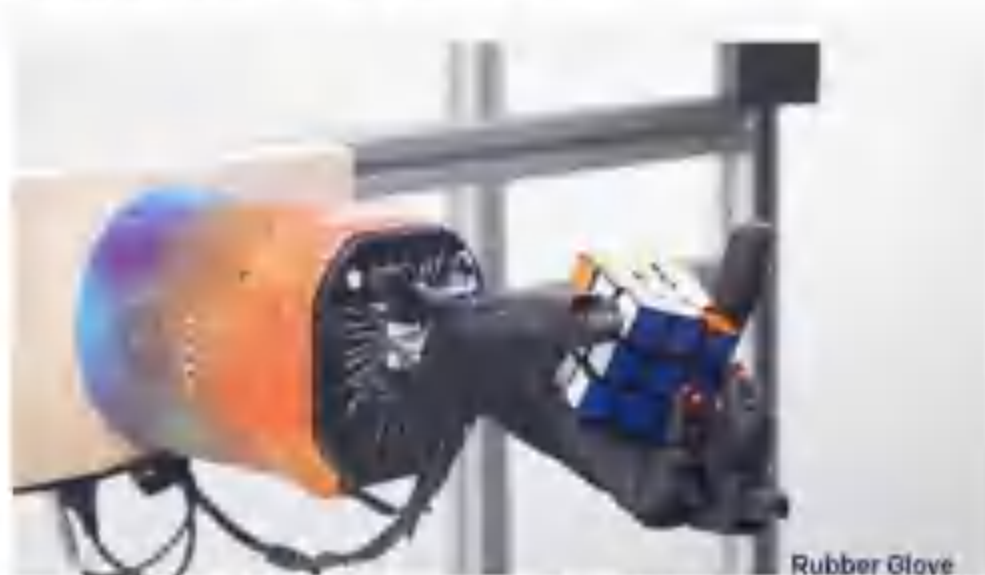
图 OpenAI 机械手单手解魔方, 成功率60%
